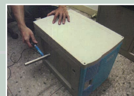
撞擊測試前照片-左面
